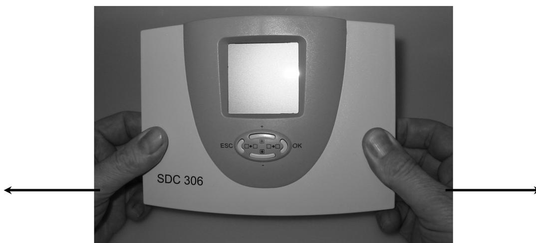
Ziehen Sie die beiden Seitenteile kräftig nach außen und klappen Sie dann das Gehäuseoberteil soweit hoch, bis dieses ein-
